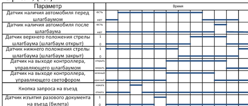
Рис. 4. Информация с датчиков, получаемая при проезде посетителя по разовому документу
